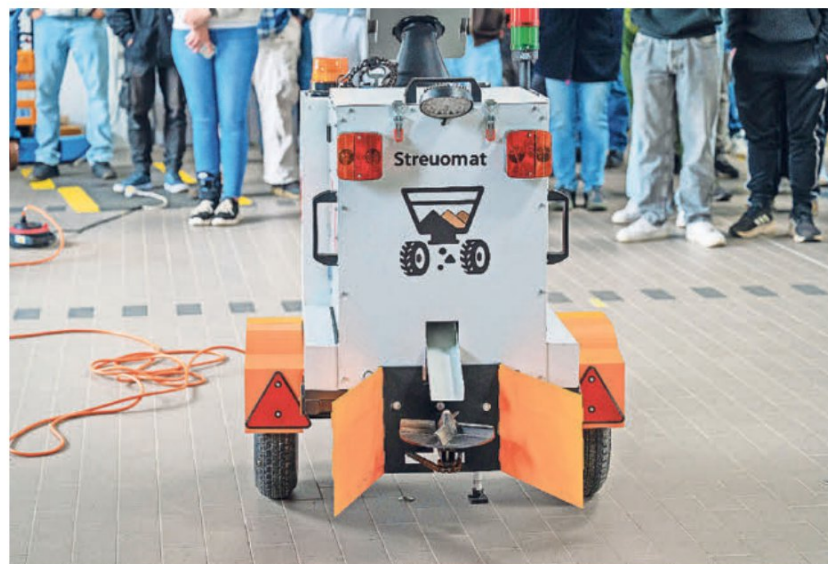
Kompakt und durchdacht: Der Streuwagen von Team „Streumat“ mit ausgefahrenen Streuklappen und drehzahlregelbarem Streuteller. Foto: Tobias Tschapka
